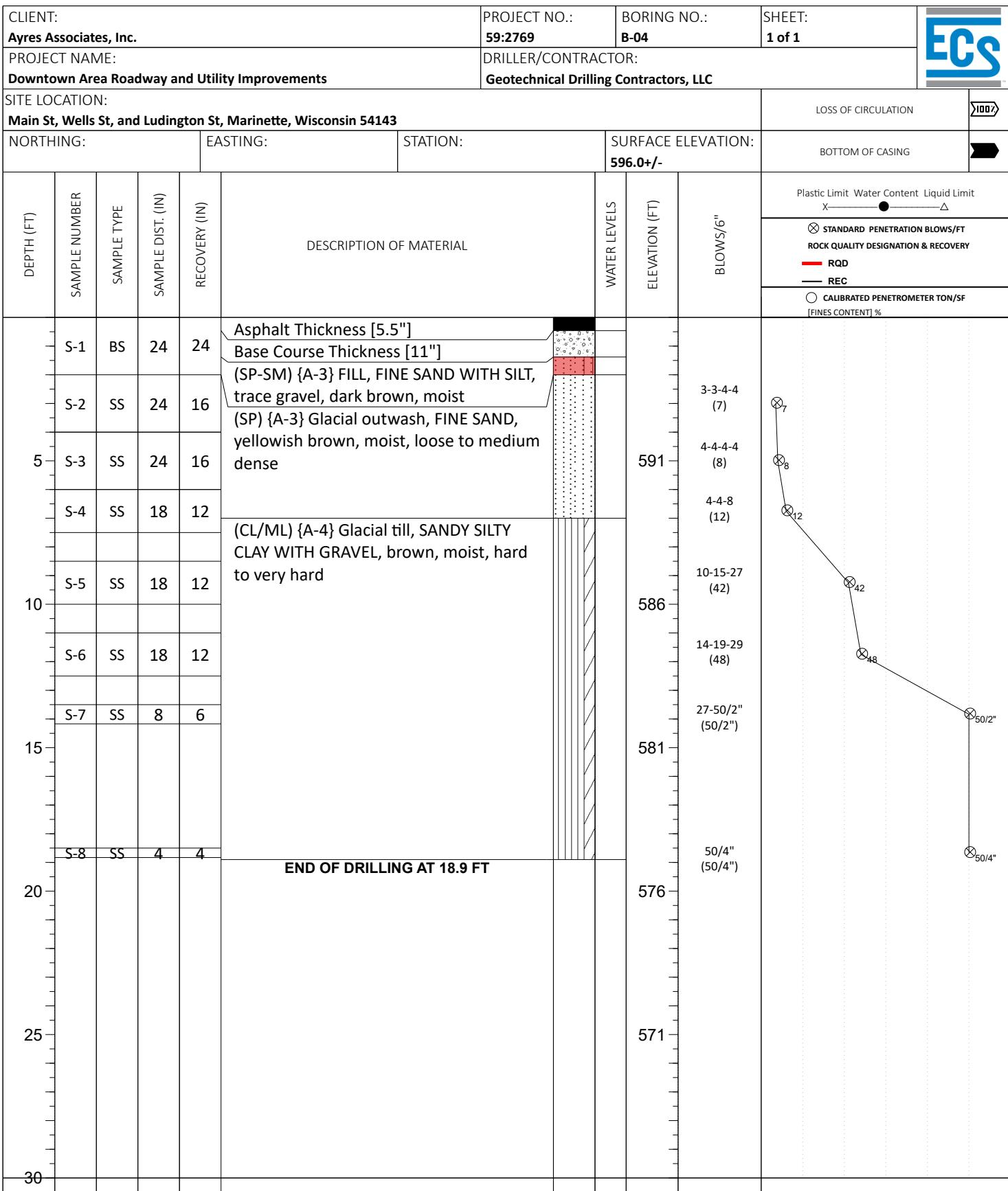
THE STRATIFICATION LINES REPRESENT THE APPROXIMATE BOUNDARY LINES BETWEEN SOIL TYPES. IN-SITU THE TRANSITION MAY BE GRADUAL
